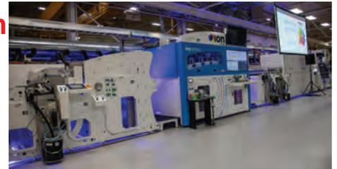
*PCMC ION shown with two flexo stations/CMYK inkjet digital/two flexo station configuration with in-line lamination. PCMC ION mit zwei Flexostationen/CMYK-Inkjetdigitaldruck/Zwei-Flexostationen-Konfiguration mit Inline-Laminierung.*
