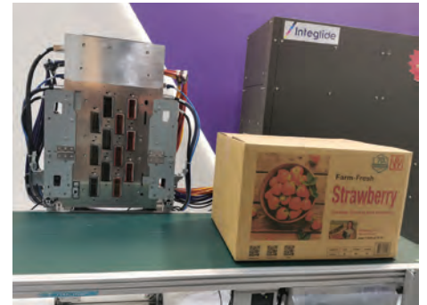
Integlide print unit and box printing example. Beispiel für Integlide-Druckwerk und Schachteldruck.
