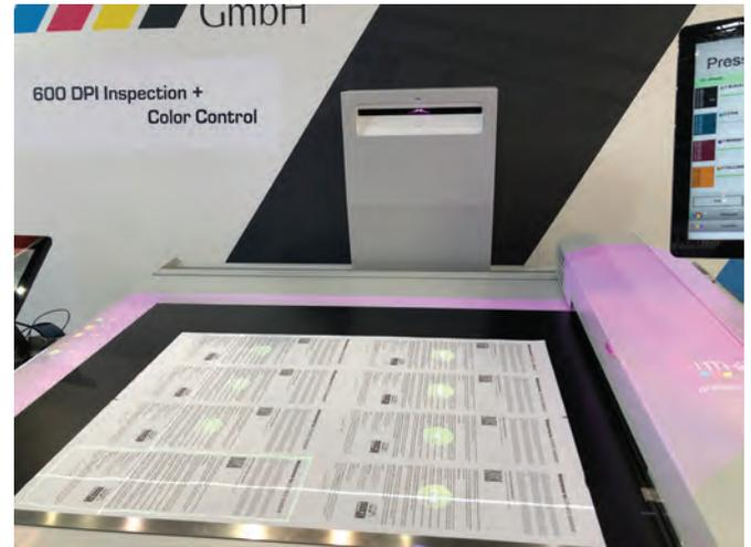
*Lithec's LithoScan SIP inspection system has a beaming feature that projects lighted indications onto areas of the sheet where problems may be occurring.* Das Inspektionssystem LithoScan SIP von Lithec verfügt über eine Funktion, die Leuchtmarkierungen auf möglicherweise problematische Bereiche des Bogens projiziert.
